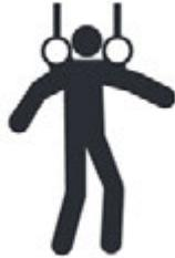
Les harnais complets de catégorie E sont conçus pour soutenir un travailleur dans une position permettant de réduire les risques lorsqu'il se déplace dans une zone d'accès restreint. Cela implique habituellement de hisser le travailleur.
